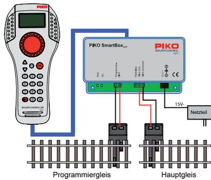
Das Programmiergleis dient ausschließlich der Programmierung von DCC-Decodern. Es ist im Fahrbetrieb stromlos und es darf keine Verbindung zum Hauptgleis bestehen.
