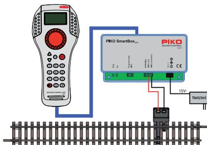
Nun schalten Sie die Betriebsspannung ein, indem Sie das Steckernetzteil in eine Steckdose stecken. Eine schaltbare Steckdosenleiste ist hier von Vorteil. Die grüne Kontroll-LED leuchtet und im **PIKO SmartController<sub>light</sub>** erscheint der Lokmodus.
