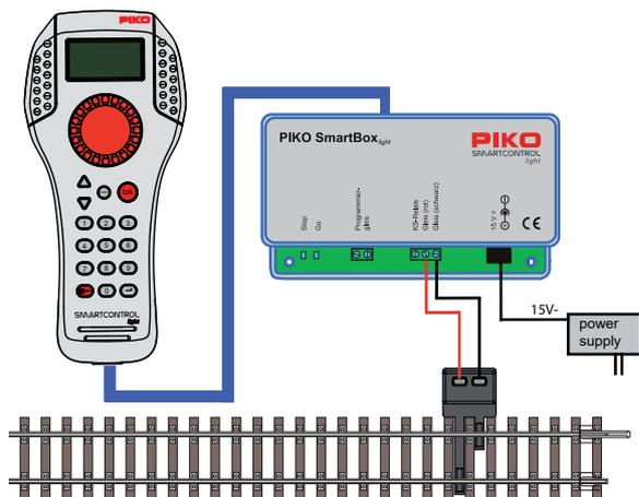
Schließen Sie **PIKO SmartControl<sub>light</sub>** Komponenten entsprechend der Aufbauskizze an und schalten sie die Betriebsspannung ein, indem Sie das Steckernetzteil in eine Steckdose stecken. Die grüne Kontroll-LED leuchtet und im **PIKO SmartController<sub>light</sub>** erscheint der Lokmodus.
