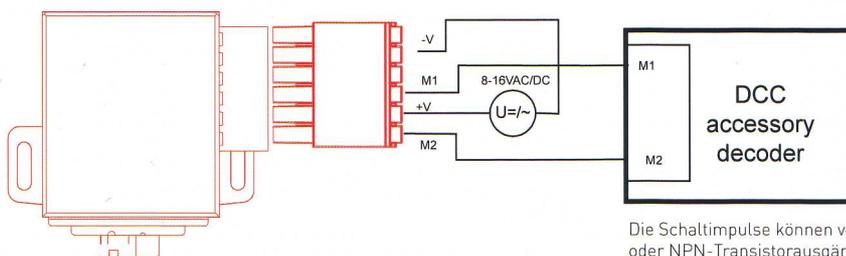
Die Schaltimpulse können von Tastern oder NPN-Transistorausgängen ausgelöst werden
