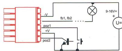
Die Schaltimpulse können von Tastern oder NPN-Transistorausgängen ausgelöst werden
