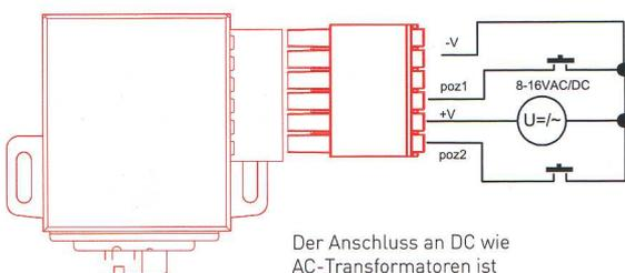
Der Anschluss an DC wie AC-Transformatoren ist möglich.
