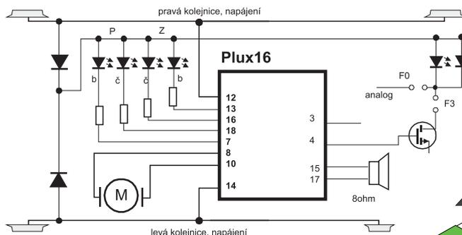
zapojení pinů Plux16, deska DPS
