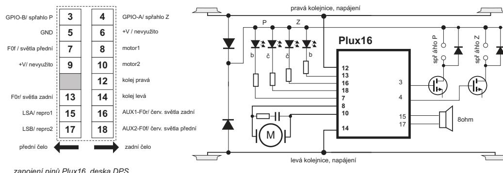
zapojení pinů Plux16, deska DPS
