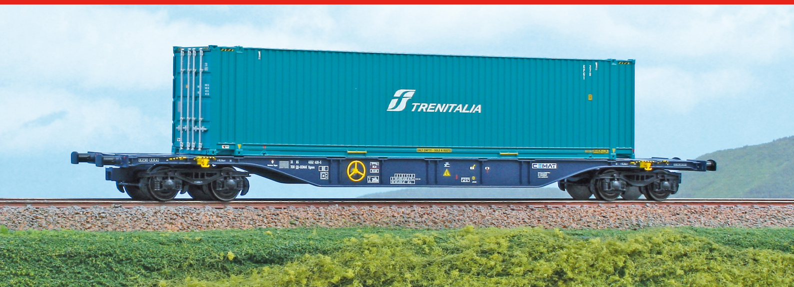
Carro intermodale Tipo Sgnss CEMAT da 60 piedi caricato con una cassa mobile furgonata "Trenitalia".
