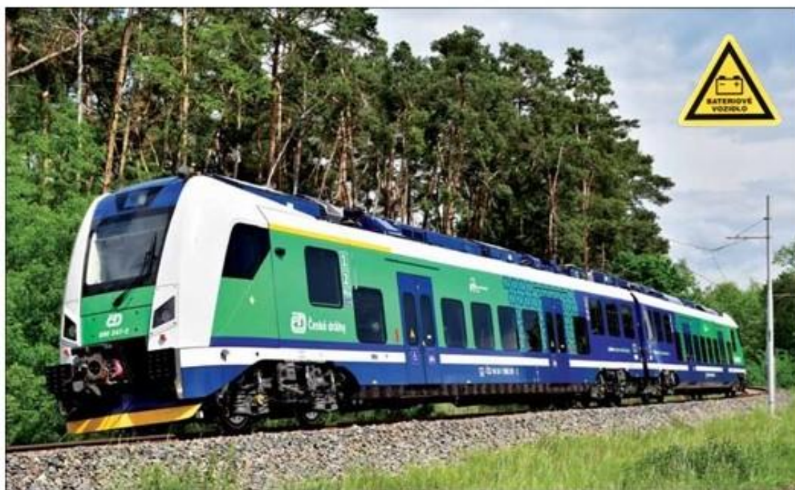
Elektrická jednotka s trakční baterií 690.247 při zkouškách na ŽZO Cerhenice (23. května 2024).
