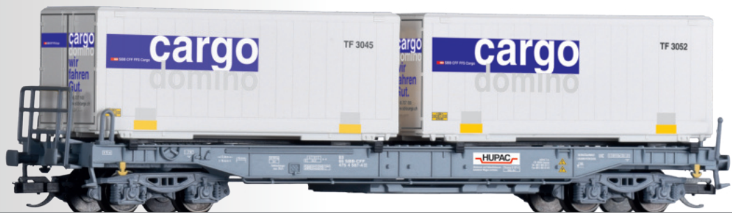
Taschenwagen Sdkmms HUPAC der SBB, beladen mit zwei Wechselbehältern Pocket wagon Sdkmms HUPAC of the SBB, with two swap bodies
