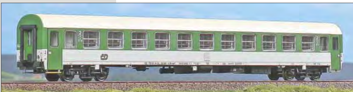
Carrozza ČD tipo Z di seconda classe in livrea verde grigio chiaro. ČD type Z 2 nd class car in green and bright grey livery. ČD Typ Z 2.Klasse Wagen, in grün und hellgrauer Lackierung.
