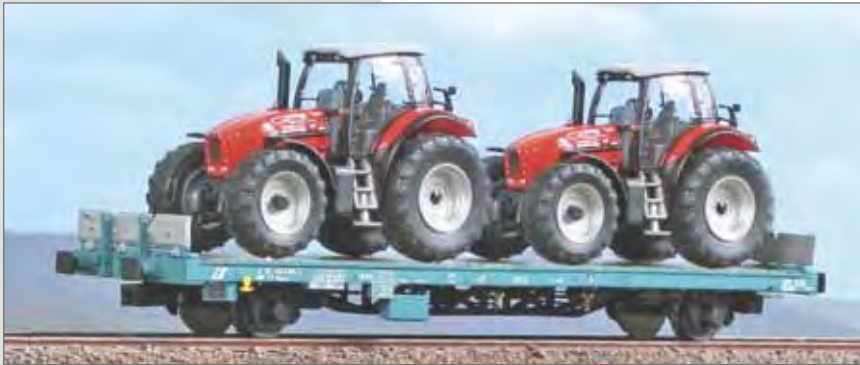
Carro pianale FS Tipo Kgps con carico di trattori. Type Kgps wagon of FS loaded with tractors. Typ Kgps FS Güterwagen mit Traktoren.
