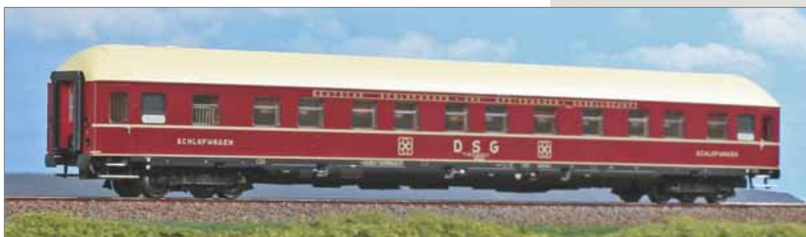
Carrozza letti WLABmh 174 con carrelli München-Kassel della DSG, in livrea rossa con carenature nere. WLABmh 174 sleeping car of DSG with München-Kassel bogies, red livery with black skirts. WLABmh 174 Schlafwagen der DSG mit München-Kassel Drehgestellen, rote Lackierung mit schwarzen Schürzen.
