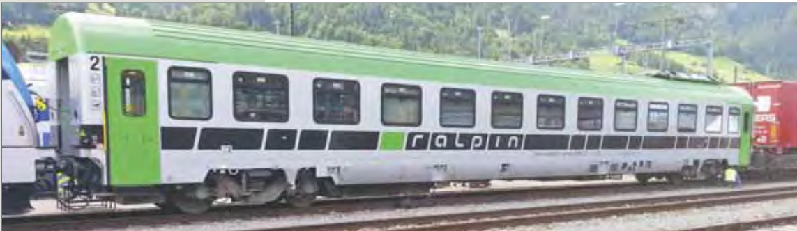
Carrozza appoggio per treni "Rollende Landstrasse" della società Ralpin. Support car of the Ralpin society, for "Rollende Landstrasse" trains. Ralpin-Begleitwagen für "Rollende Landstrasse"-Züge.
