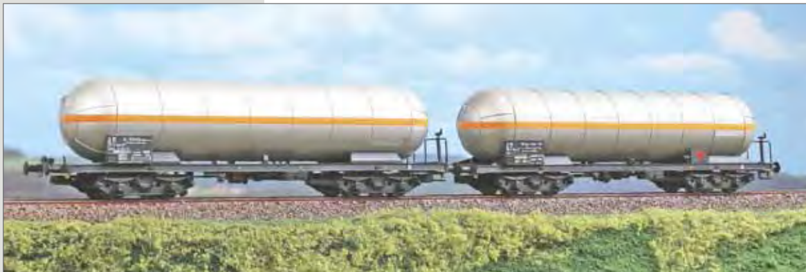
Coppia di carri cisterma Zagkk immatricolati presso le FS dalla società Ultragas. Set of two Italian Railways Zagkk tank wagons, owned by Ultragas Set aus zwei Tankwagen Zagkk, der Gesellschaft Ultragas, bei der FS eingestellt.
