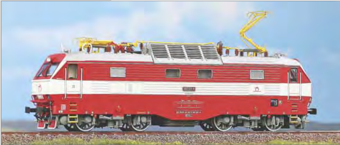
Locomotiva polintensione Classe 350 001 delle Ferrovie Slovacche ZSSK per servizi internazionali. Class 350001 locomotive of the ZSSK (Slovakian Railways) for international services. E-Lok Baureihe 350 001 der ZSSK (Slowakische Eisenbahnen) für internationale Dienstleistungen.
