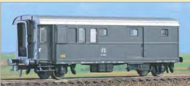
Bagaglio a due assi serie DI 90000, livrea grigio ardesia. Two-axle luggage car series 90000 of the FS, slate gray livery. Zweiachsiger Gepäckwagen DI 90000 der FS, schiefergraue Lackierung.
