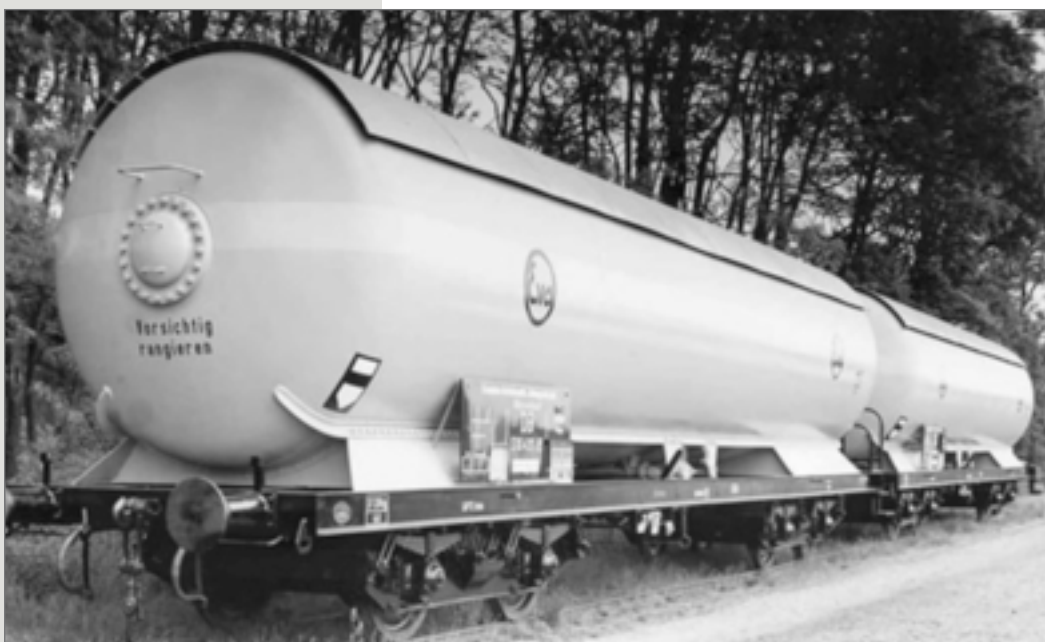
Set di due carri trasporto gas della società EVA immatricolati presso le DB. Set of two gas tank wagons owned by EVA, registered at DB. Set aus zwei Gaskesselwagen der Gesellschaft EVA, bei der DB eingestellt.
