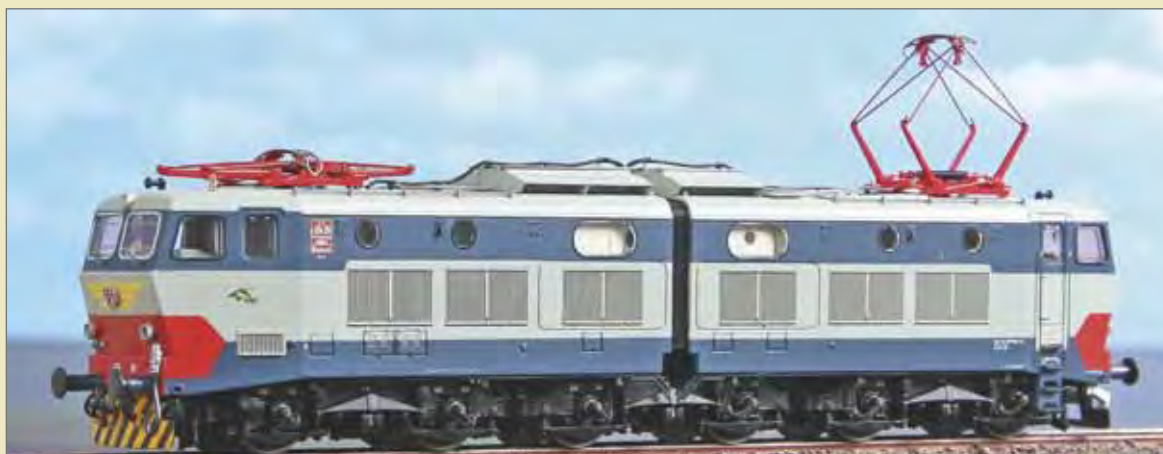
Locomotiva articolata delle FS E.656.204 (seconda serie). Livrea di origine, pantografi Tipo FS 52, respingenti tondi.
