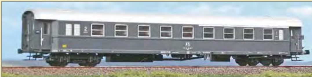
Carrozza cuccette Tipo 1959 – mista 1a e 2a classe, livrea grigio ardesia, carrelli 24. Couchette car Typ 1959, mixed first and second class gray livery, bogies FS 24. Typ 1959 1./2. Klasse Liegewagen, schiefergraue Lackierung, FS24 Drehgestelle.
