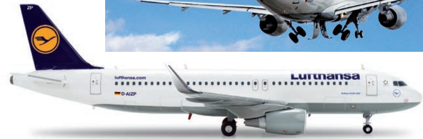
556132 Lufthansa Airbus A320 mit / with Sharklets – D-AIZP Am 1. März 2013 übernahm die größte deutsche Airline ihren ersten werksneuen A320 mit den neuen, 2,4 Meter hohen „Sharklets“ an den Tragflächenenden. Zusätzlich zur Spriteinsparung kann der A320 mit den Sharklets schneller steigen und reduziert somit zudem die Lärmbelastung. / On March 1st, 2013, Germany's largest airline took delivery of its first factory-new A320 with the new, 2.4 meter tall "sharklets" on the wingtips. In addition to the fuel savings, the A320 can climb at a steeper angle, therefore reducing noise emissions. 1/200 49,50 €
