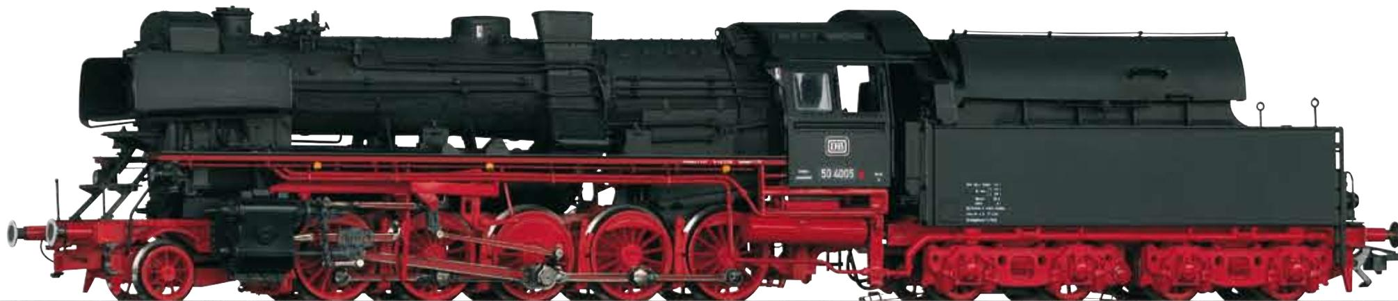
*Nach intensiven Versuchen mit den beiden Franco-Crosti Lokomotiven der Baureihe 42.90 entschied sich die Deutsche Bundesbahn, mehrere Loks der BR 50 dementsprechend umzubauen. Bei einem Franco-Crosti Kessel handelt es sich um einen herkömmlichen Lok-Kessel mit nachgeschaltetem zweitem Kessel. Dieser erwärmt das Speisewasser mit Hilfe der vorbeiströmenden Rauchgase. Dieser zweite Kessel*
