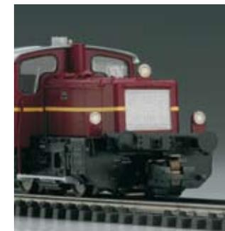
schaltbar. Beleuchtung mit warmweißen LED. Spitzensignal an beiden Seiten abschaltbar. Telex-Kupplung vorne und hinten getrennt schaltbar. Freier Durchblick im Führerhaus, Griffstangen angesetzt. Länge über Puffer der Lok 9 cm. Gesamtlänge über Puffer 32,4 cm.
