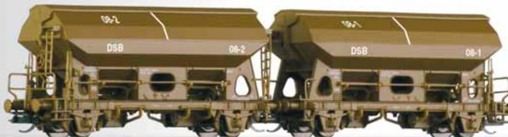
Schwenkdachwagen-Einheit Tdgrrs der DSB, zweiteilig
