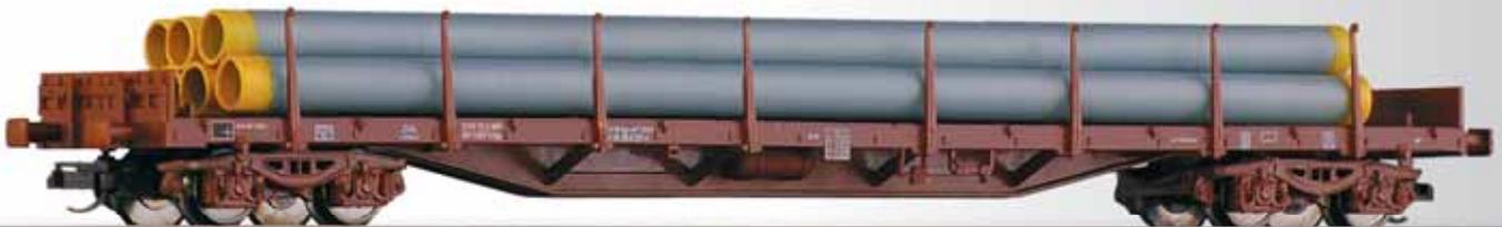
Rungenwagen Rgs der MAV, beladen mit Rohren
