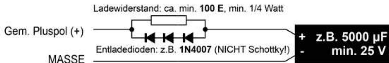
Der Widerstand verhindert zu hohen Ladestrom (Inrush current), die Dioden ermöglichen durch den Spannungsabfall Service-Mode-Programmieren sowie Software-Update und Sound-Laden trotz größerer Kapazitäten.
