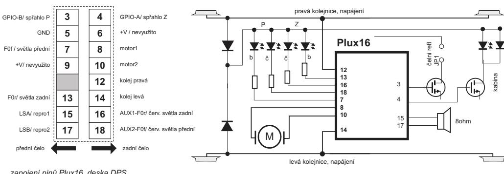
zapojení pinů Plux16, deska DPS
