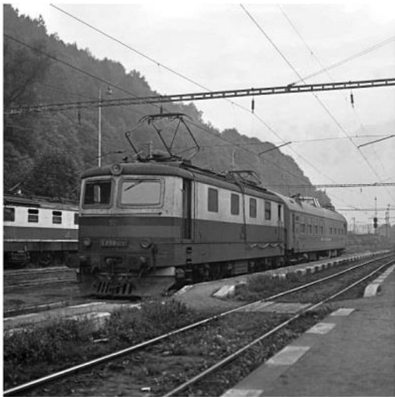
9. září 1986 projel po trati mezi Ústím nad Orlicí a Letohradem měřicí vlak, který tvořila Bobina E 499.1026 společně s měřicím vozem trakčního vedení. Na snímku je uvedená souprava zachycena po návratu z Letohradu v Ústí nad Orlicí. Za povímanými stoji kabely natažené z měřicího vozu na střešku a sbírají lokomotivy. (foto Jiří AdOLF, sbírka Martin Žabka)
