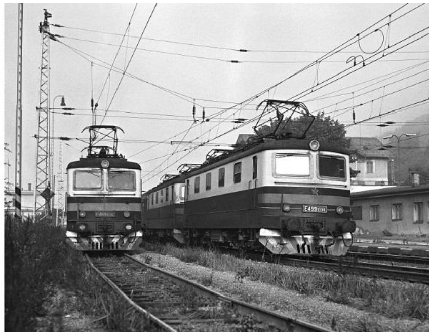
9. září 1986 projel po trati mezi Ústím nad Orlicí a Letohradem měřicí vlak, který tvořila Bobina E 499.1026 společně s měřicím vozem trakčního vedení. Na snímku je uvedená souprava zachycena po návratu z Letohradu v Ústí nad Orlicí. Za povímanými stoji kabely natažené z měřicího vozu na střešku a sbírají lokomotivy. (foto Jiří AdOLF, sbírka Martin Žabka)
