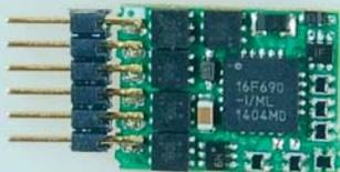
Alle Lokdecoder sind kompatibel zum DCC-Standard der NMRA. Sie können die Decoder mit allen Zentralen und Systemen verwenden, die ebenfalls kompatibel zum NMRA-Standard sind, z.B. Lenz (compact, LZVI00), Uhlenbrock (Intellibox), Arnold, Roco, Fleischmann (TwinCenter), Digitrax, Zimo (MX1) u.v.a..
