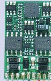
Der **N025** zählt zu den kleinsten Lokdecodern der Welt. Durch modernste Bauteil- und Leiterplattentechnologie betragen die Abmessungen des Decoders gerade einmal 11,4 x 8,8 x 3,3 mm. Der Motorausgang ist mit bis zu 700 mA belastbar, die einzelnen Funktionsausgänge können jeweils mit 150mA belastet werden. Alle Ausgänge des Decoders besitzen Schutzeinrichtungen, die im Falle eines Kurzschlusses den Decoder abschalten.
