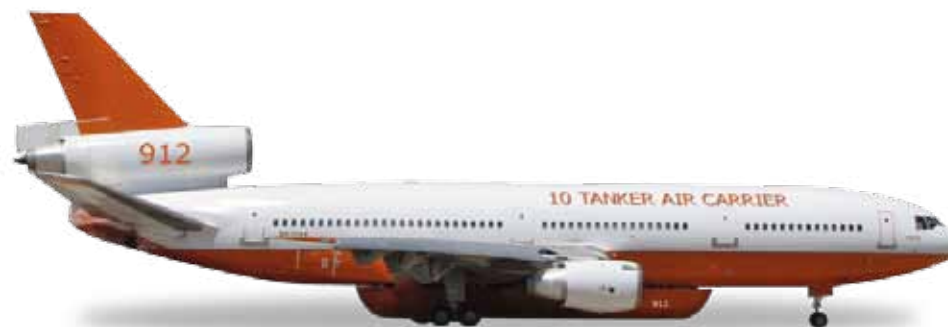
529082 10 Tanker Air Carrier McDonnell Douglas DC-10-30 – N522AX / 912 Vier DC-10 wurden bislang mit einem 45.000 Liter großen Zusatztank unter dem Rumpf ausgestattet. Seit 2006 werden die Maschinen erfolgreich zur Waldbrandbekämpfung in den USA, aber auch nach Australien eingesetzt. / Four DC-10s have been equipped with the large belly tank holding up to 45,000 liters or 12,000 gallons of water or fire retardant. The aircraft started seeing use in 2006, and have since successfully operated against wildfires in the US and Australia.
