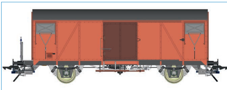
Gms 54 Gedeckter Güterwagen mit Bremserbühne, DB - Art. Nr. 42235-01
