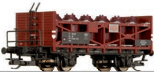
Säuretopfwagen der DR Acid pot car of the DR
